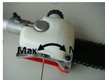
La vis de réglage du débit d'huile doit être légèrement enfoncée pour le tourner. Le non-respect de cette consigne pourrait endommager la pompe et la vis.
